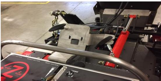
(Diffuser cable & Hopper cable)
